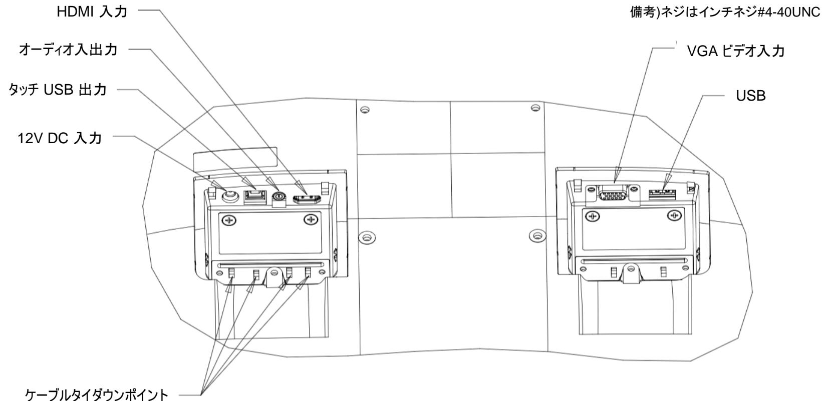
注: ケーブルタイダウンポイントを使用して、ケーブルをタイラップで結ぶことができます。ケーブルタイダウンポイントを通して、ケーブルの周りにタイラップを巻き付けて、ケーブル接続を固定します。
