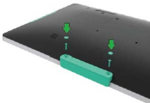
同梱されたネジで、ステータスライトを固定し、必要に応じてネジの上に、カバーを貼り付け終了です
