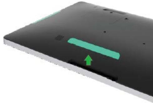
Edge Connect 周辺機器カバーを取り外して、周辺機器ベイを露出させます。
